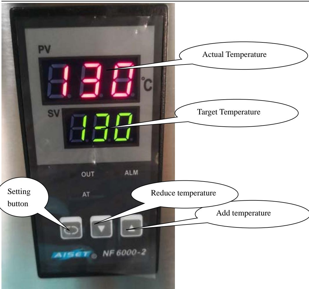
Actual temperature: machine actual sealing temperature;
